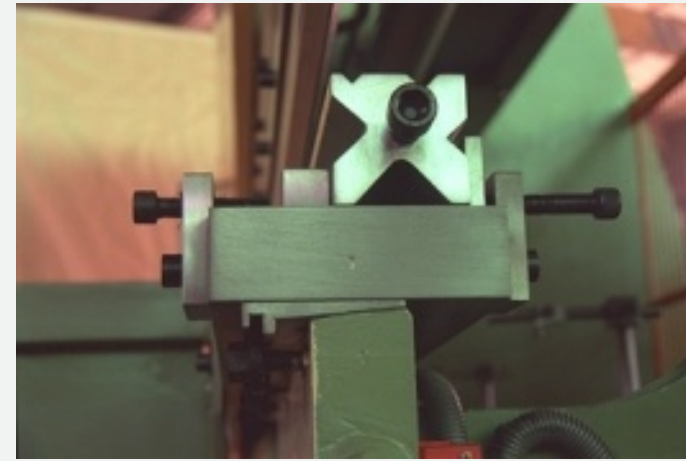
Cuñas de regulación micrométrica del plegado a lo largo de la máquina Micrometric shims to regulate the fold along the machine Cales de réglage micrométrique du pliage tout le long de la machine
