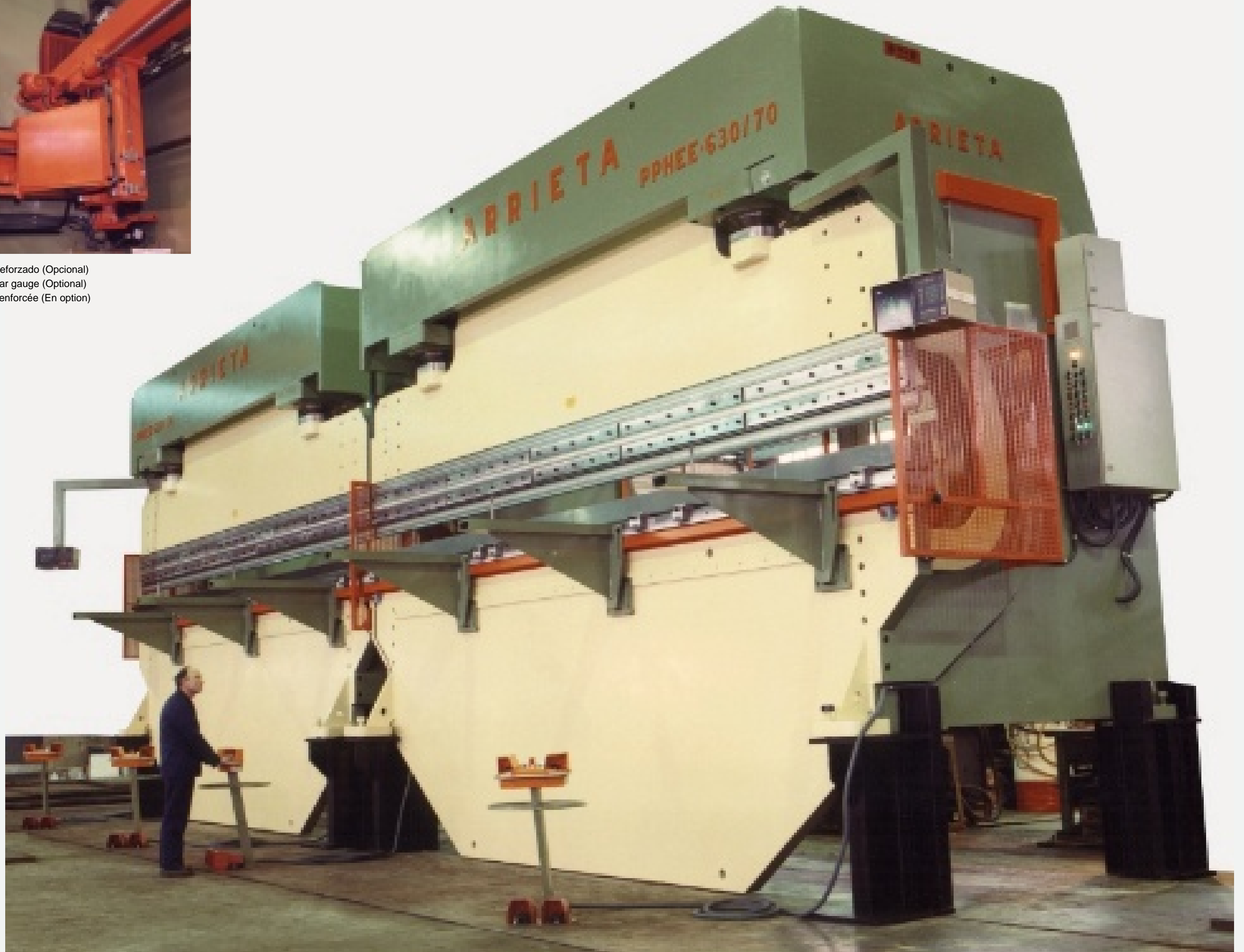
Dos plegadoras independientes de 630 Tn x 7.100 mm de longitud ó una plegadora tándem de 1.260 Tn x 14.200 mm de longitud Two independent press brakes or one tandem 1.260-Ton x 14.200 mm press brake Deux presses plieuses de 630 Tn et de 7.100 mm de longueur ou une presse plieuse tandem de 1.260 Tn et de 14.200 mm de longueur
